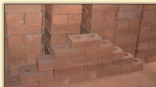
Blocs de terre comprimée (BTC), Norme NC 105 - 114 : 2002, produits avec du sable, de la terre
