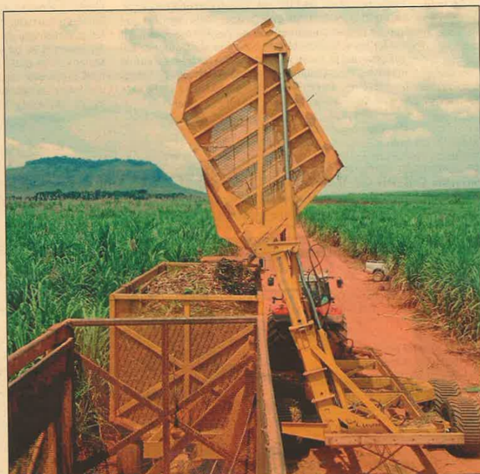
Legras Industries (Epernay) commercialise notamment des remorques élévatrices pour le transport et le transfert de la canne à sucre en Afrique.
